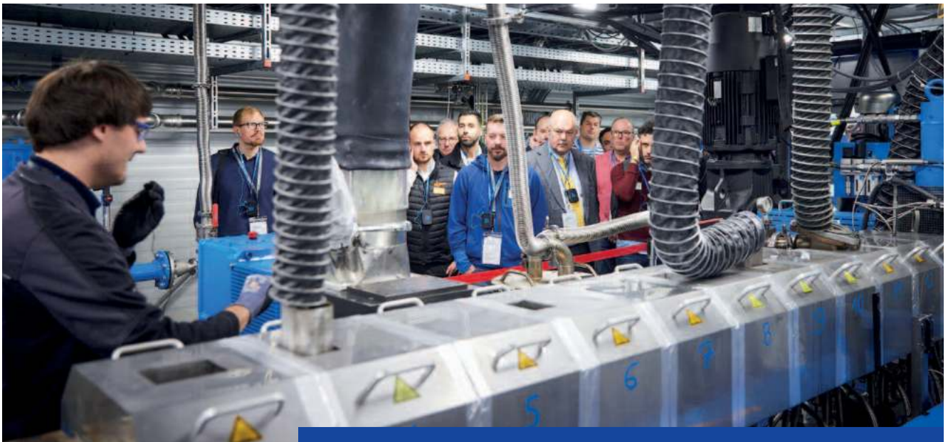
Die Live-Vorführung rund um einem ZSK 58 Mc 18 Recycling-Extruder zeigte eindrucksvoll, wie dank innovativer Zusatzaggregate rPE-Flakes trotz ihrer geringen Schüttdichte mit äußerst hohen Durchsätzen zu rPT-Granulat verarbeitet werden können (Bilder: Coperion, Stuttgart)
