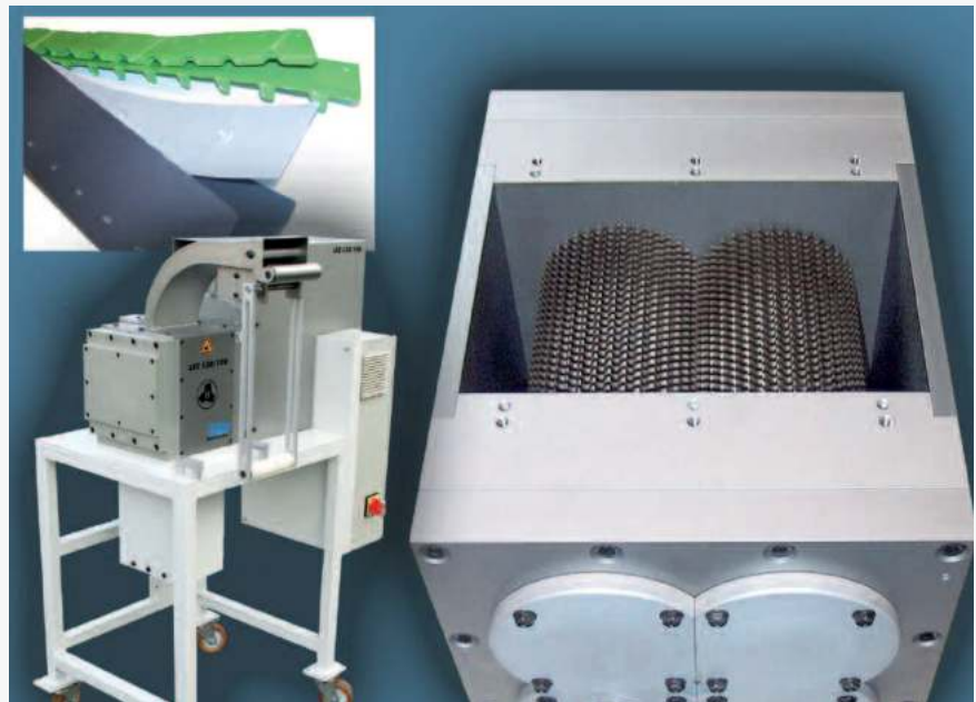
Vier paarweise übereinander angeordnete Zahnwalzen aus gehärtetem Werkzeugstahl ziehen auch stark profilierte Randstreifen sicher ein und zerkleinern sie in einem Schritt (© Hellweg Maschinenbau)
