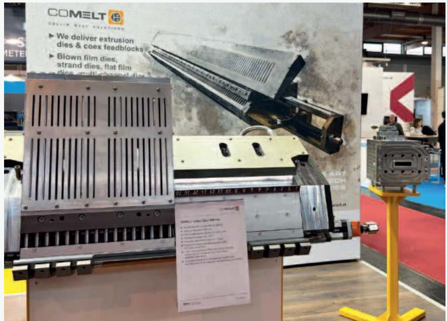
COMELT 800 mm Hochtechnologie-Extrusionsdüse coflex (© COMELT GmbH)
