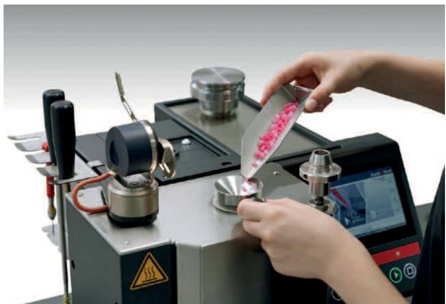
Einfüllen und prüfen von Kunststoff-Granulat
