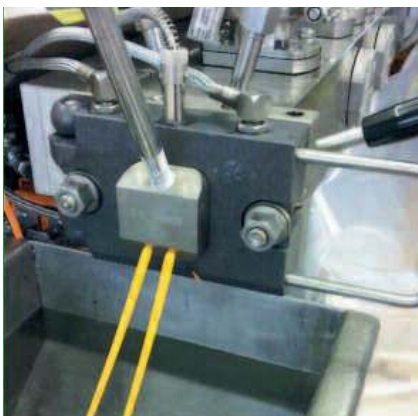
Rechts: ColVisTec Extruder Messsonde für Reflexion und Transmission Unten links: ColVisTec Reflexionssonde im Extruder Einsatz
