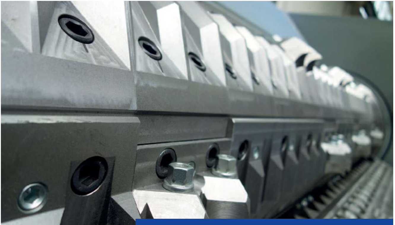
Rotor eines Einwellenshredders 60/210 mit aufgeschraubten Messerkassetten (Alle Bilder: Herbold Meckesheim)
